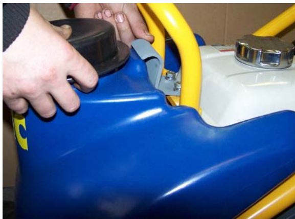
Obr. Demontáž vodní nádrže kropení
