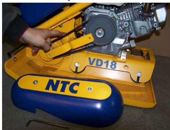
Obr. Kontrola napnutí klínového řemenu
