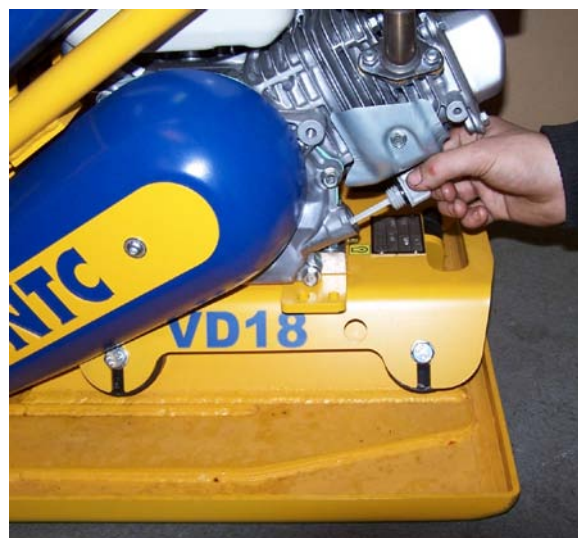
Obr. Kontrola hladiny motorového oleje
